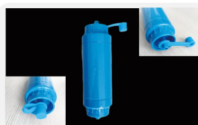
型号 : MAX-T-0001E 尺寸 Size : \text{Ø}40 \times 85\text{mm} 流量 Flow : 1000-4000ml/min 工作压力 Working pressure : 0.05-0.4MPa 可乐瓶螺纹 Coke bottle female thread
