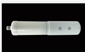
型号 : MAX-F-M6 尺寸 Size : \varnothing 60 \times 285 mm 流量 Flow : 2000-6000ml/min 压力 Pressure : 0.1-0.4MPa 前段 : 炭棒/PP棉 Front section : carbon rod, PP cotton
