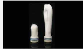
型号 : MAX-B-M15 尺寸 Size : \text{Ø}41 \times 100/200\text{mm} 流量 Flow : 1000-4000ml/min 压力 Pressure : 0.1-0.4MPa 可用PS、PVDF膜丝 PS/PVDF fiber
