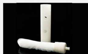
型号 : MAX-B-M28 尺寸 Size : \text{Ø}60 \times 253\text{mm} 流量 Flow : 2000-8000ml/min 工作压力 Working pressure : 0.1-0.4MPa 可用PS、PVDF膜丝 PS/PVDF fiber
