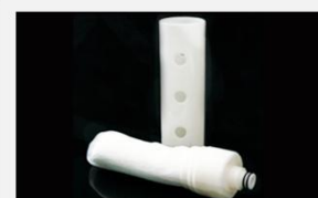
型号 : MAX-B-M29 尺寸 Size : \text{Ø}60 \times 218\text{mm} 流量 Flow : 2000-8000ml/min 工作压力 Working pressure : 0.1-0.4MPa 可用PS、PVDF膜丝 PS/PVDF fiber
