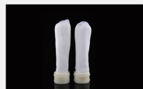
型号 : MAX-B-M18 尺寸 Size : \text{Ø}51 \times 200\text{mm} 流量 Flow : 2000-4000ml/min 工作压力 Working pressure : 0.1-0.4MPa 可用PS、PVDF膜丝 PS/PVDF fiber
