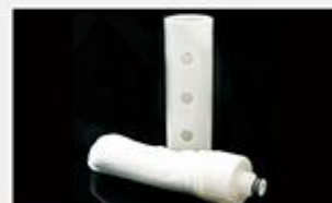
型号 : MAX-B-M29 尺寸 Size : Ø60×218mm 流量 Flow : 2000-8000ml/min 工作压力 Working pressure : 0.1-0.4MPa 可用PS、PVDF膜丝 PS/PVDF fiber
