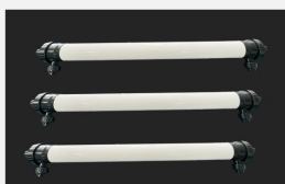
型号 : 4040 尺寸 Size : \text{Ø}90 \times 1210\text{mm} 接口 Connector : \text{Ø}32 , DN25 流量 Flow : 1T/h 工作压力 Working pressure : 0.1-0.4MPa
