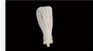
型号 : MAX-B-M35 尺寸 Size : Ø45×200mm 流量 Flow : 2000-5000ml/min 工作压力 Working pressure : 0.1-0.4MPa 可用PS、PVDF膜丝 PS/PVDF fiber 1/4" 螺纹 thread
